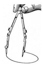
Para dibujar una circunferencia se utiliza otro instrumento geométrico: el compás. Se clava una punta, llamada seca, en un punto de un plano, mientras que la otra punta, llamada punta de trazado, se desliza sobre el plano describiendo la curva.
